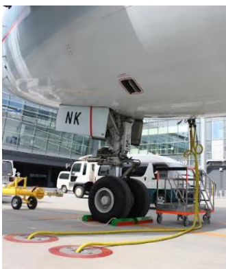
〈埋め込み式ケーブル 電力供給〉 〈埋め込み式ホース 冷暖房供給〉
