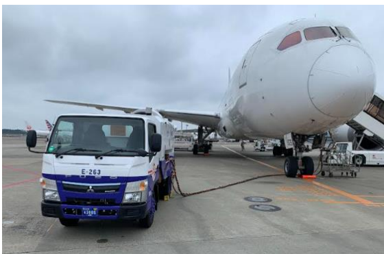
〈移動式 電力供給〉
