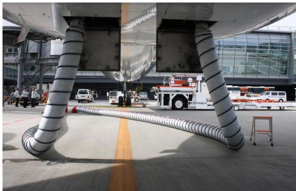
〈埋め込み式ケーブル 電力供給〉 〈埋め込み式ホース 冷暖房供給〉
